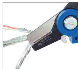
Schneiden der Paarschirmung Cutting the double shielding
